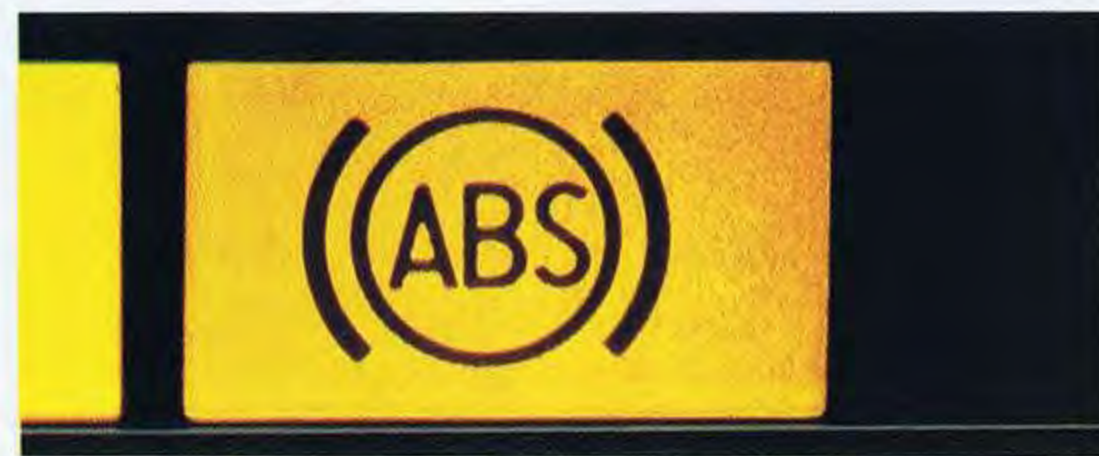
アンチロック・ブレーキング・システム(ABS)。フル制動時にもステアリングを切って正確にコントロールすることができます。
