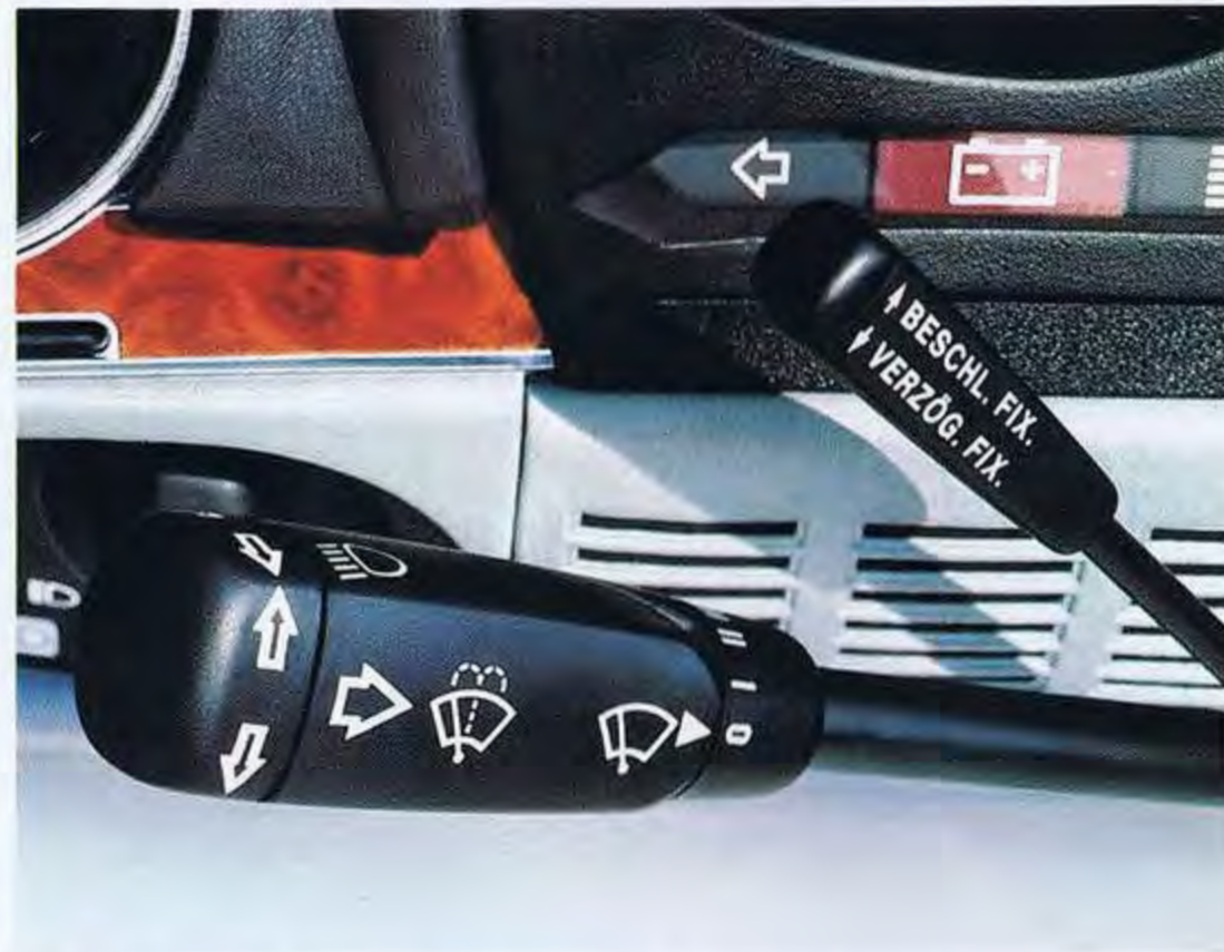
コンビネーションスイッチ。ヘッドライトのロービーム、ハイビーム切り換え、パッシング、方向指示、ウインドシールドワイパー/ウォッシャーシステムの総合スイッチです。右上はクルーズコントロールレバーです。
