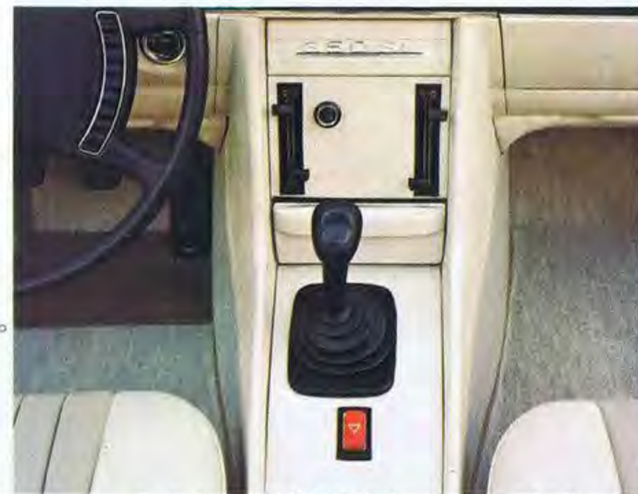
フロアシフトレバーはセンターコンソール上にセットされ安全のためにパッドの施されたノブが採用されています。
