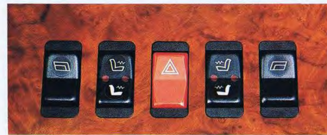
(中央から左右へ)ハザード、シートヒーター、パワーウィンドウの各スイッチ。
